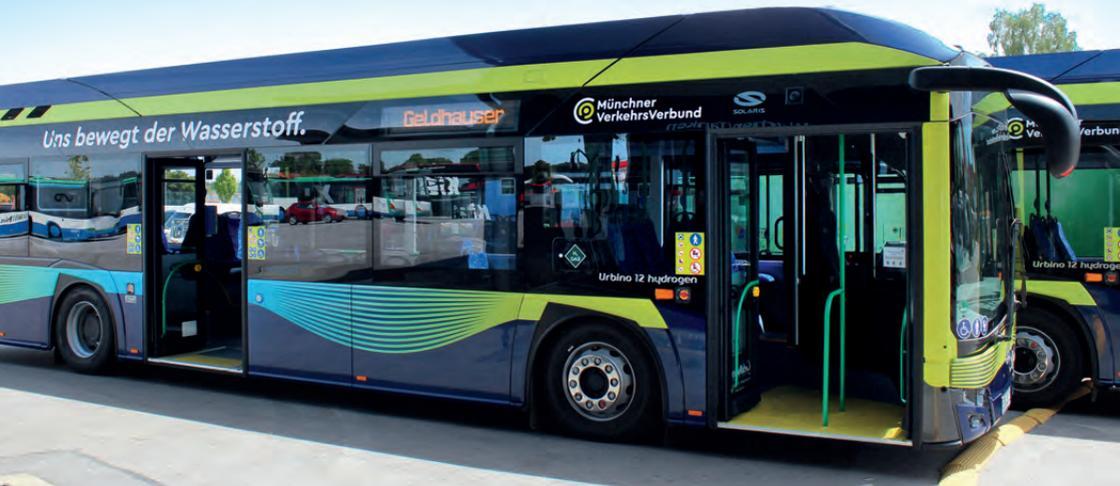
Der Wasserstofftank und die Brennstoffzelle befinden sich in einem unauffälligen Dachaufbau, die Außen-gestaltung der Brennstoffzellen-Busse symbolisiert die neue und umweltfreundliche Antriebstechnologie.
